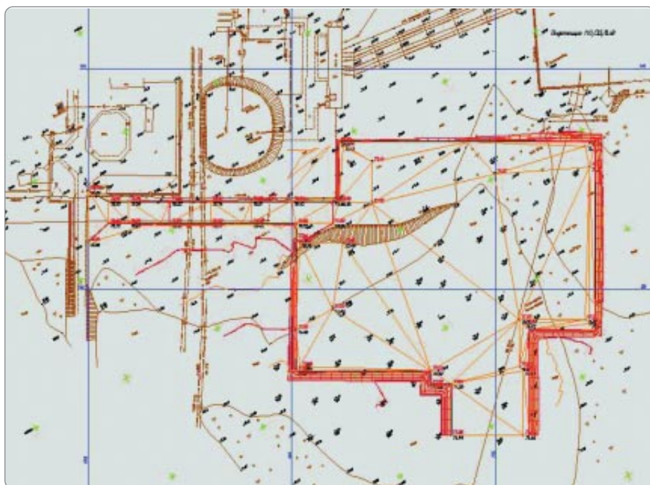
Создание поверхности подсыпки с 3D-откосами
